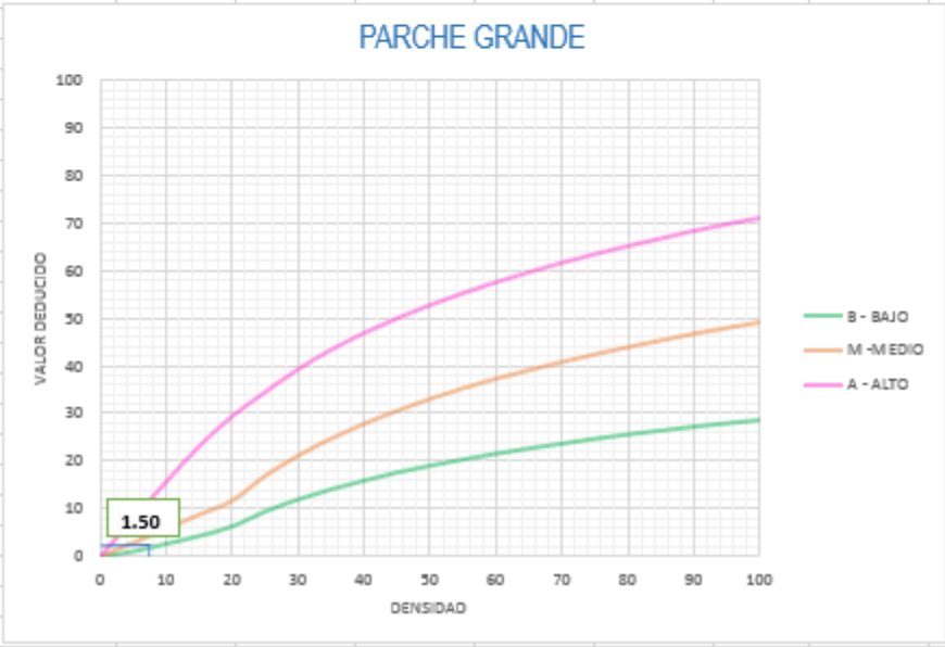
Figura 65: Patología del pavimento rígido – Parcheo Grande, UM-03
