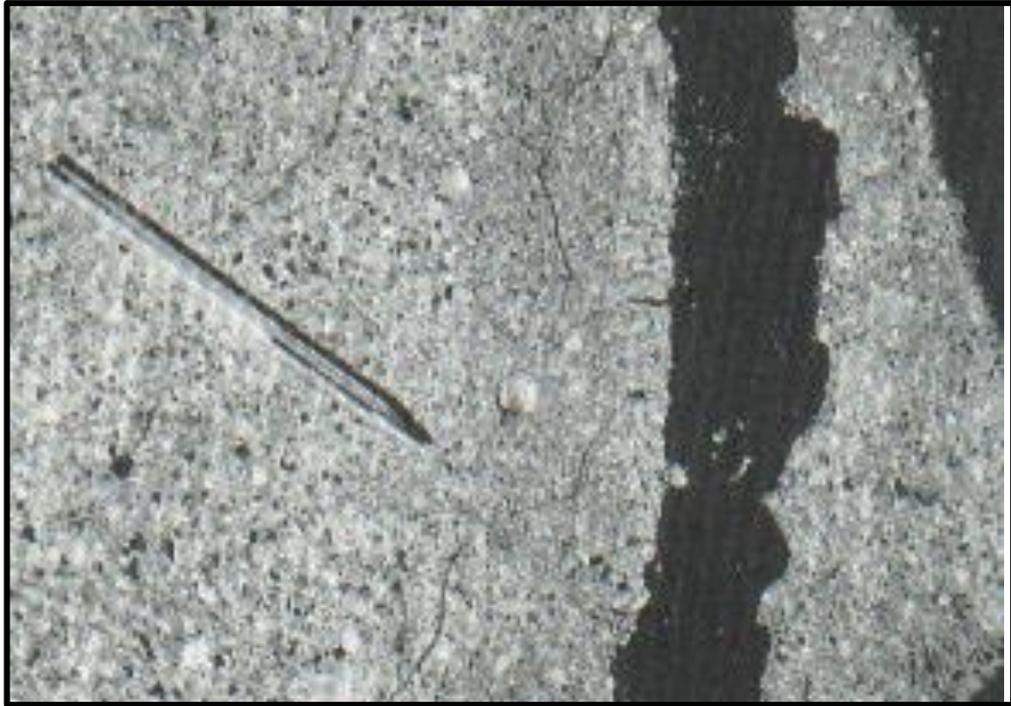
*Figura 17: Grieta de durabilidad de severidad baja*
