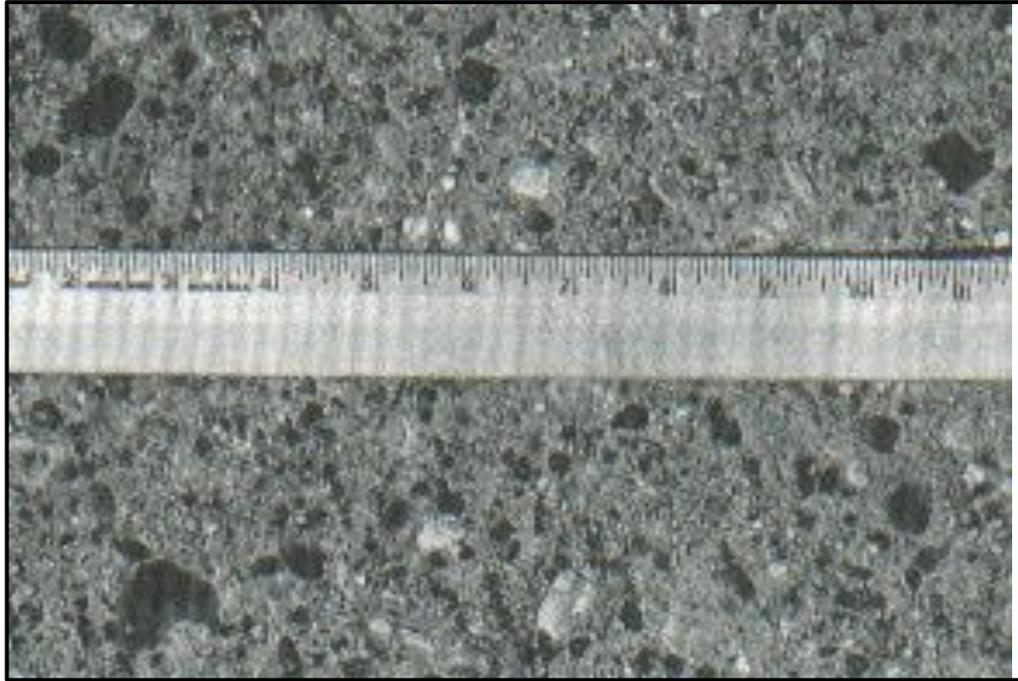
*Figura 38: Pulimento de agregados.*
