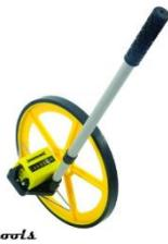
Herramienta que se utiliza para medir grandes distancias, esta herramienta fue utilizada en la medición longitudinal de las progresivas del pavimento estudiado.
