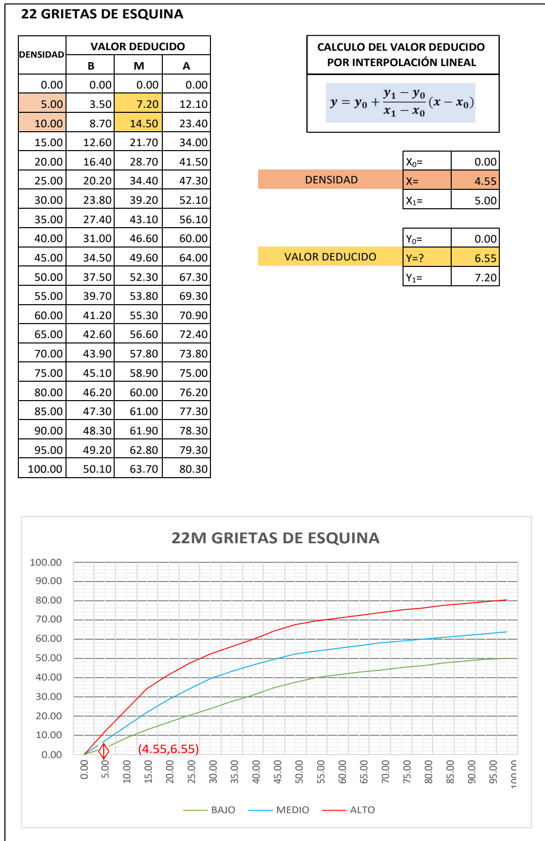
Cuadro IV-268: Valor Deducido Grieta de esquina - UM - 16.
