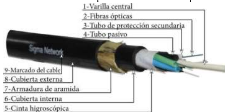
Gráfico Nro. 13: Componentes de una fibra óptica
