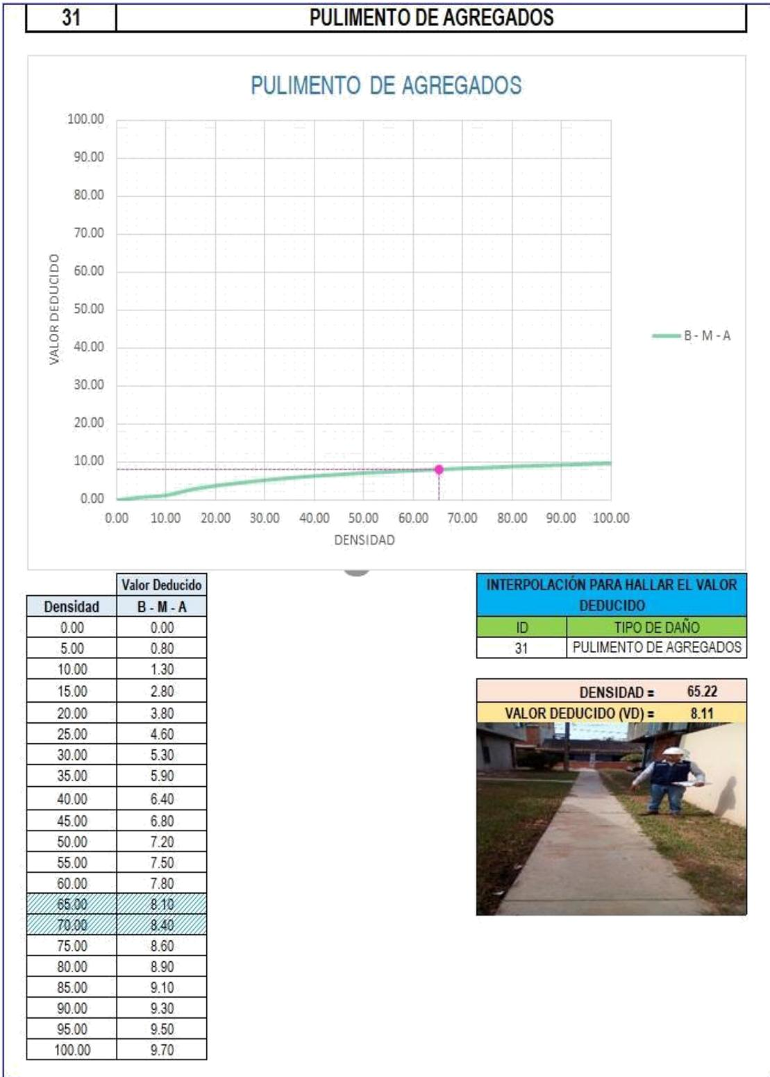
**Figura N° 58:** V.D. pulimento de agregado, UM 01 – MZ D
