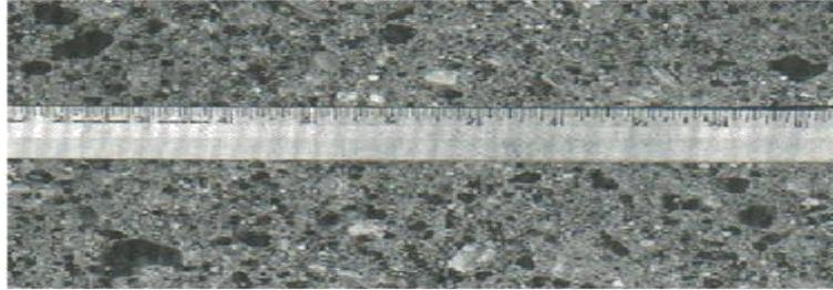
**Figura N° 20:** Pulimento de Agregados
