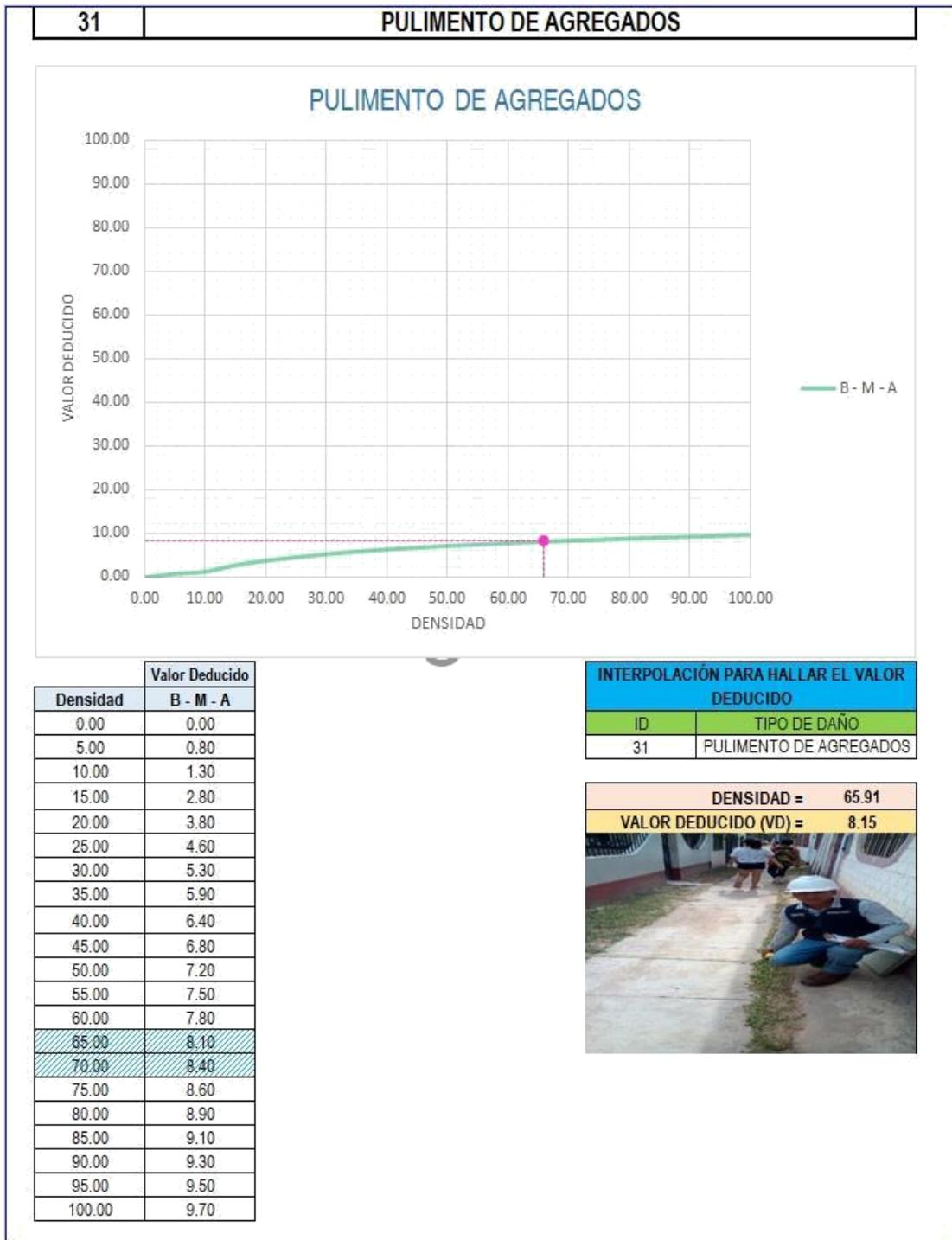
**Figura N°41:** V.D de pulimento de agregado, UM-01- MZ-B
