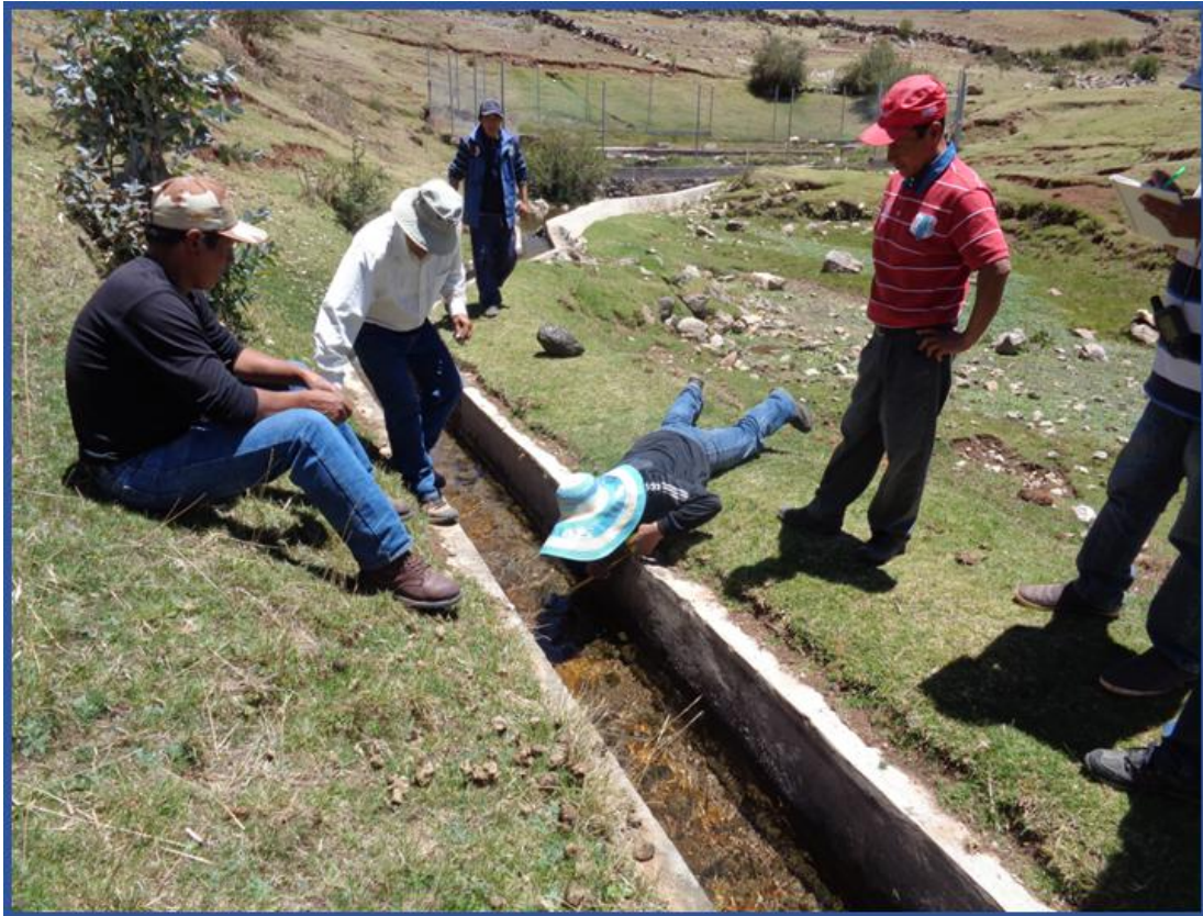
Figura 4.10: Técnicos de Campo conjuntamente con los usuarios realizando el aforo por el método volumen fuente Huayllancucho 01
