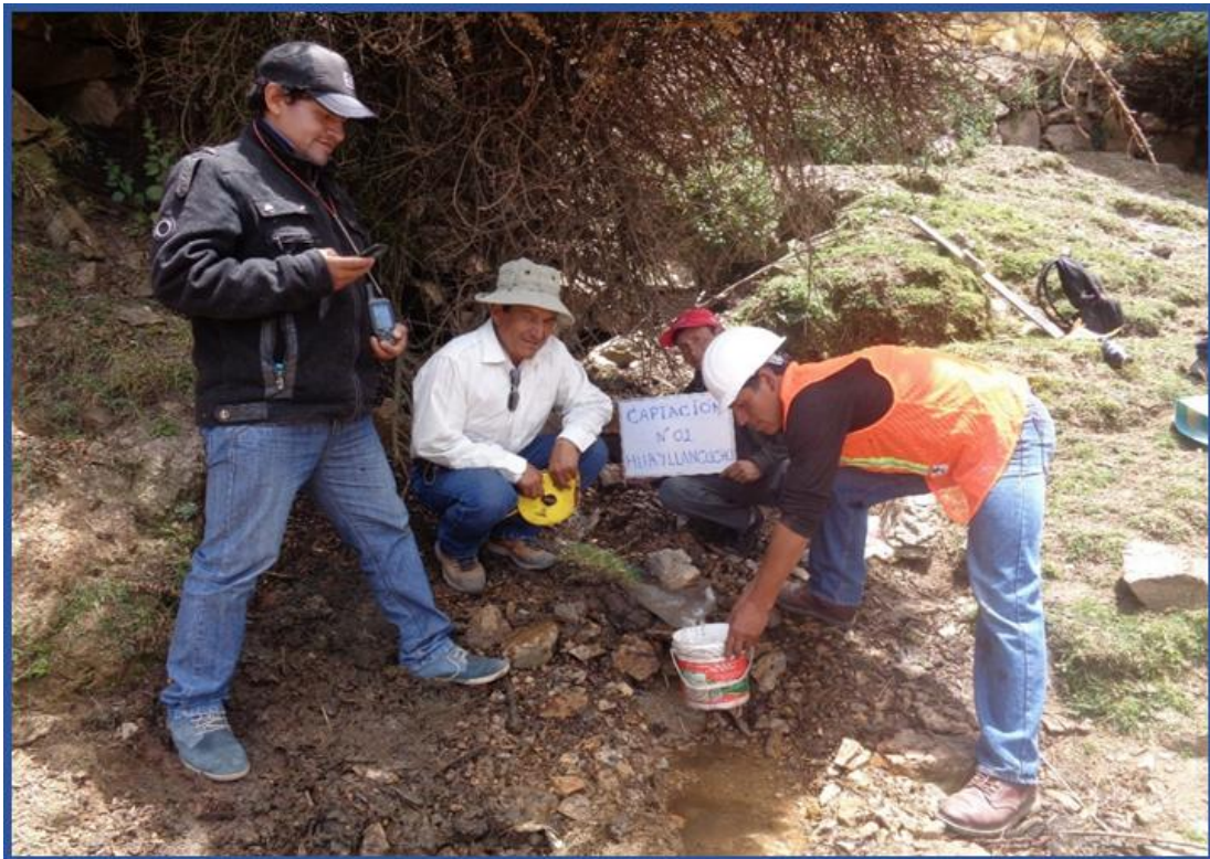
Figura 4.5: Técnicos de Campo conjuntamente con los usuarios realizando el aforo por el método volumen fuente Huayllancucho 01
