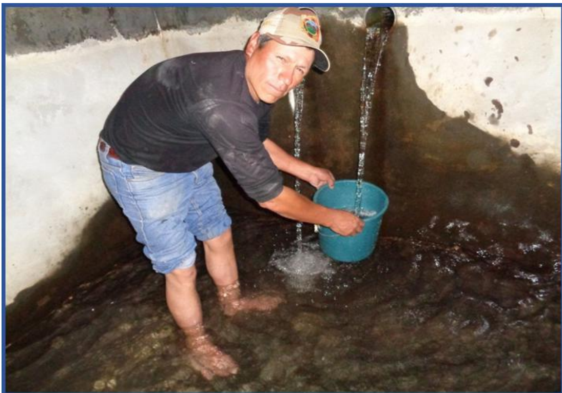
Figura 4.8: Aforo por el método volumen fuente Viscachayocc.
