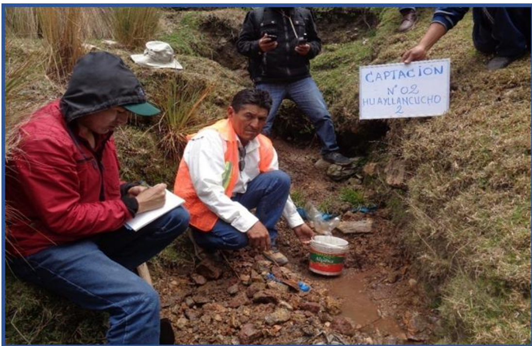
Figura 4.6: Técnicos de Campo conjuntamente con los usuarios realizando el aforo por el método volumen fuente Huayllancucho 02
