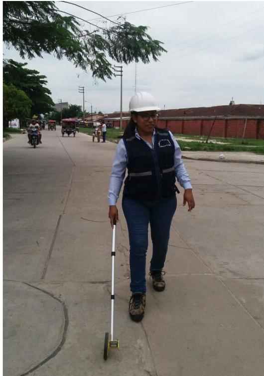
**Fotografía 4:** Realizando las mediciones de los daños y las distancias de las losas.
