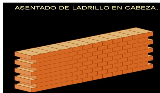
Figura 4: Asentado de ladrillo en cabeza
