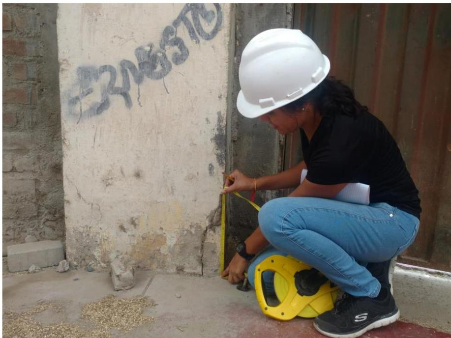
*Figura 12.* Medición de área afectada por patologías
