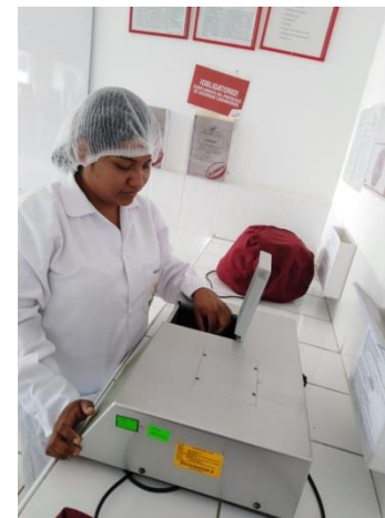
Realizo la lectura en el espectrofotómetro a una longitud de onda de 532 nm.
