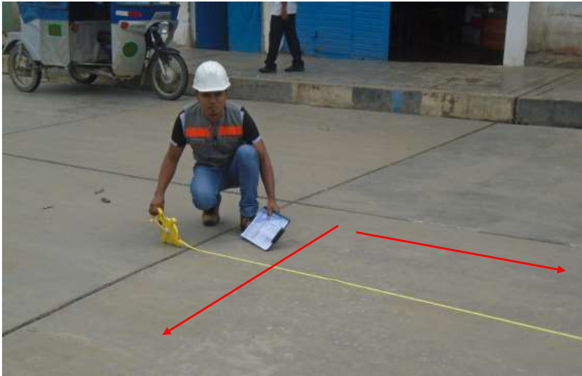
Figura 175. En la fotografía se observa la medición de la losa de la unidad de muestra 2.
