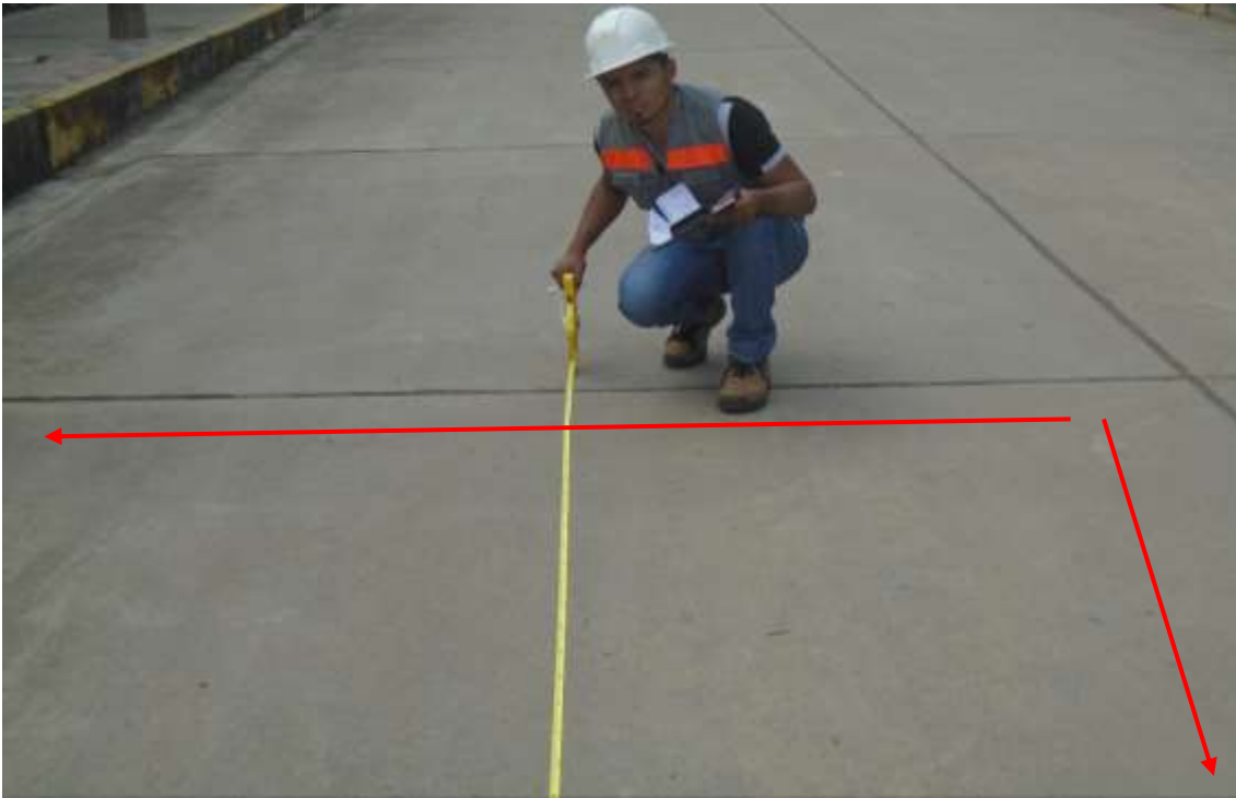
Figura 191. En la fotografía se observa la medición de la losa de la unidad de muestra 6.
