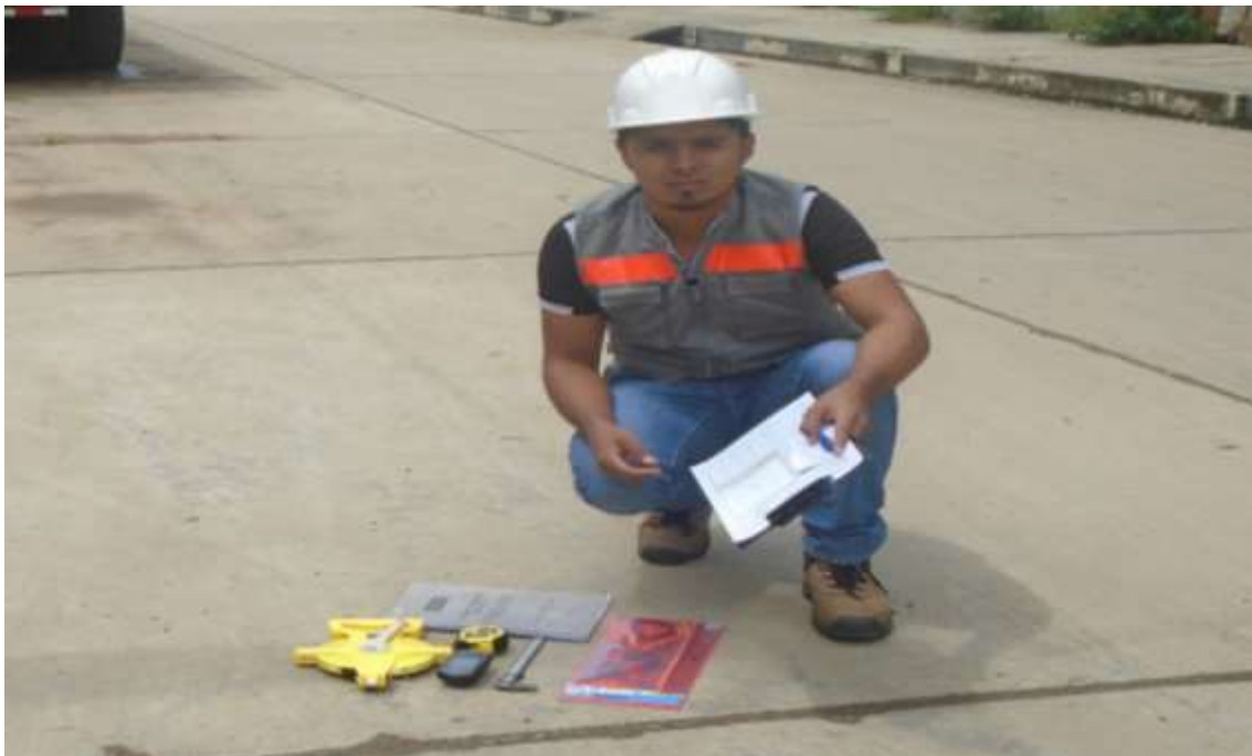
Figura 147. En esta imagen se puede observar un vernier, un flexómetro, un juego de reglas, una wincha, un manual del PCI, un GPS, una cámara digital y hojas de inspección.
