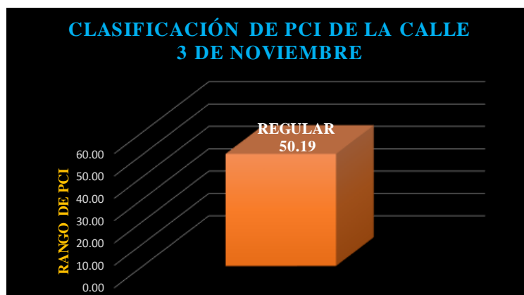
Figura 55: Clasificación del PCI de la calle 3 de Noviembre de la U – 04, 6ta. Cuadra.
