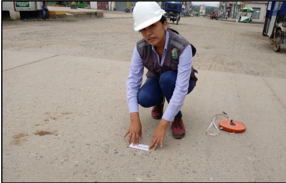
Figura 91: Pulimento de agregados en la calle 7 de Junio para la UM-03.
