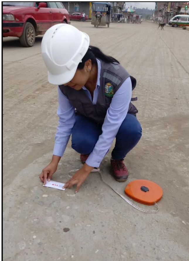
Figura 88: Pulimento de agregados en la calle 7 de Junio para la UM-02.
