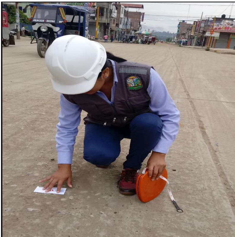
Figura 84: Pulimento de agregados en la calle 7 de Junio para la UM-01.
