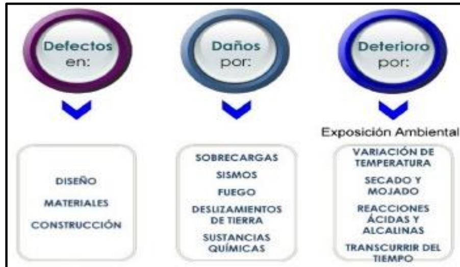
Figura 10. Clasificación general de patologías.
