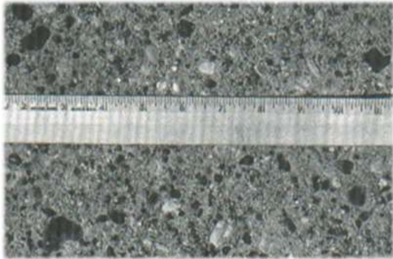
Figura 19: Pulimento de agregados.
