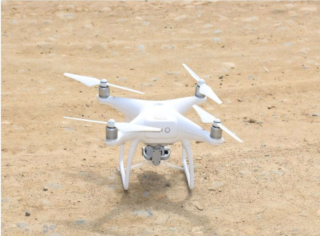
Imagen 24: Utilización de dron con sistema integrado de fotografía y medición
