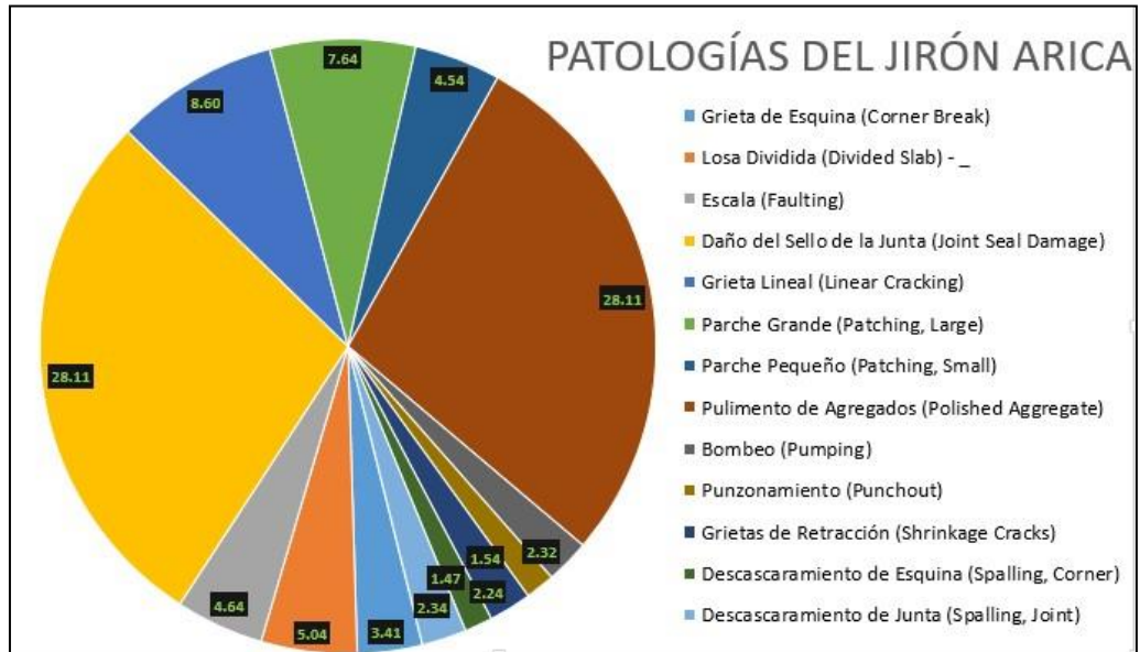
Figura 70: Gráfico de Índice de Patologías Generales Registradas en el Pavimento Rígido del Jirón Arica.
