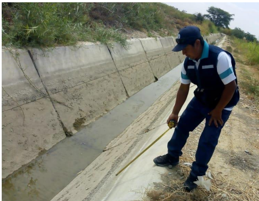
Gráfico 72: Determinando las dimensiones del canal.
