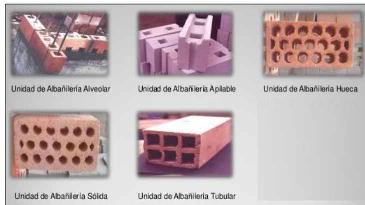
Figura 11. Tipos de unidades de albañilería. Fuente: Ministerio de Vivienda, Construcción y Saneamiento (2010)
