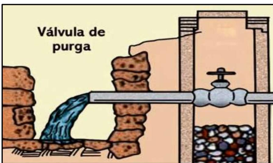
**Ilustración 13.** Vista de perfil de válvula de purga.
