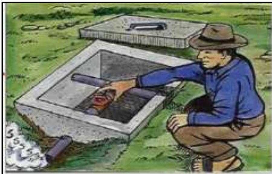
**Ilustración 11.** Válvula de aire.
