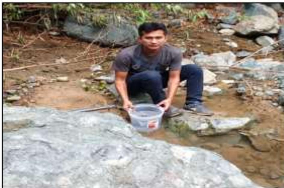
**Ilustración 34.**Aforo de captación de agua.
