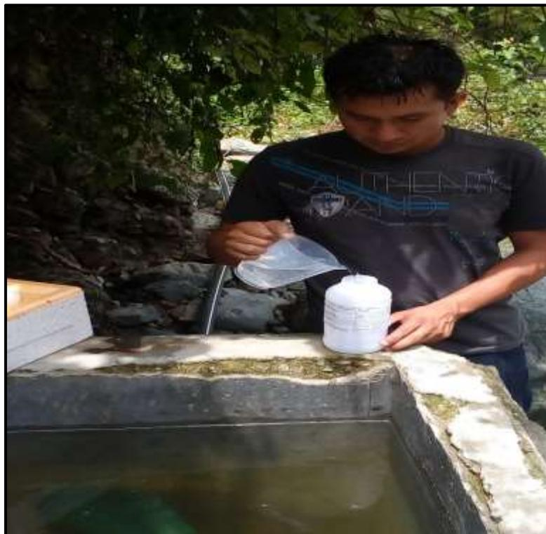
**Ilustración 32.** Muestra de agua para ensayo Físico-químico
