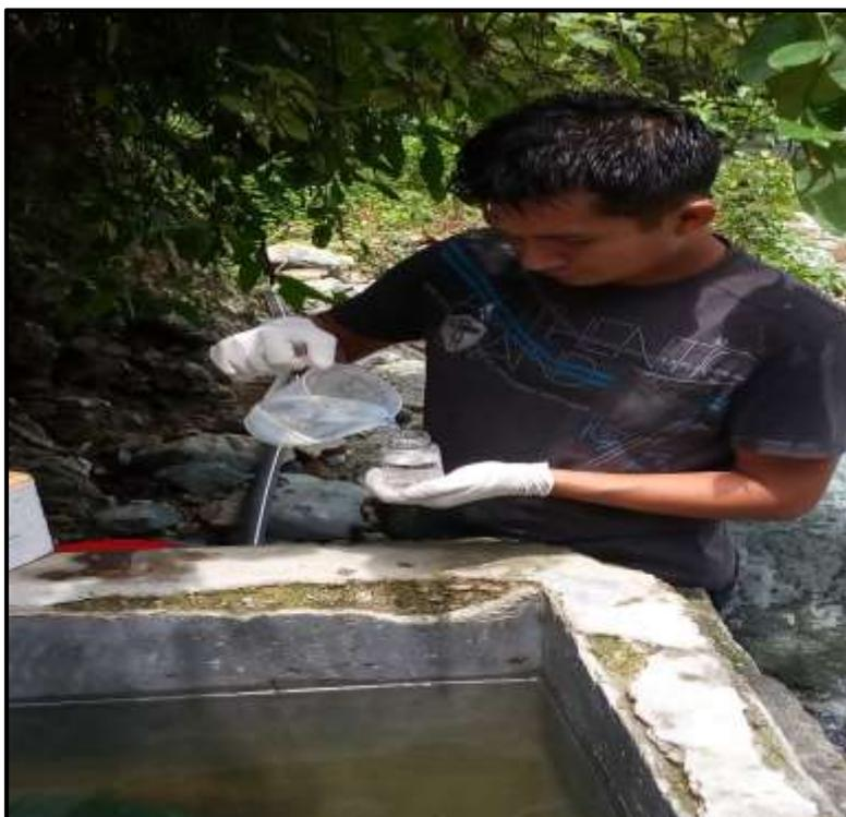
**Ilustración 33.** Muestra de agua para ensayo bacteriológico en laboratorio.
