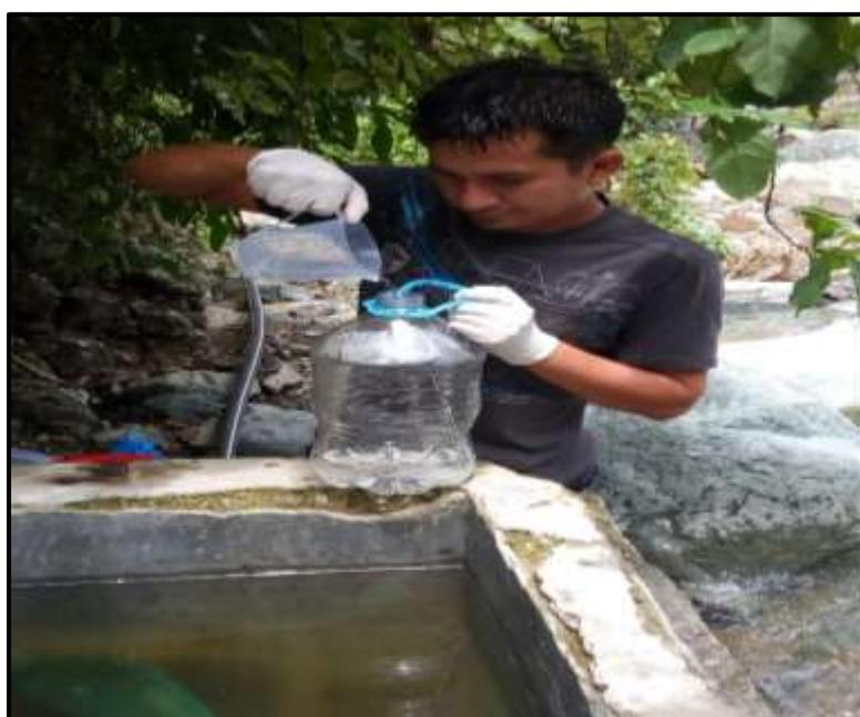
**Ilustración 34.** Muestra de agua para ensayo bacteriológico en laboratorio.
