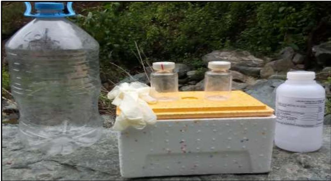
**Ilustración 31.** Instrumentos utilizados para muestras de agua
