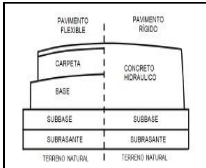
Gráfico N° 2.1: Elementos de un pavimento
