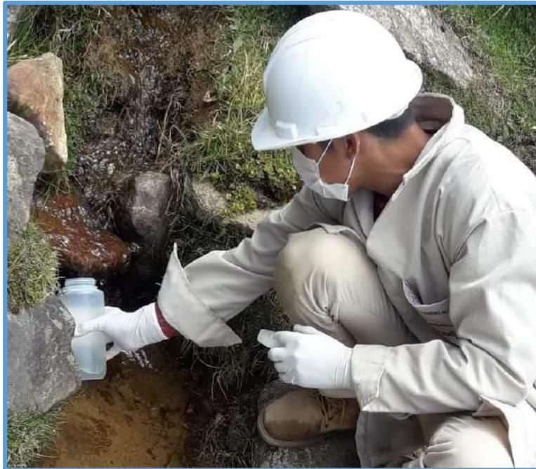
Fotografía 13: En esta fotografía se puede apreciar el recogimiento de la muestra de agua.
