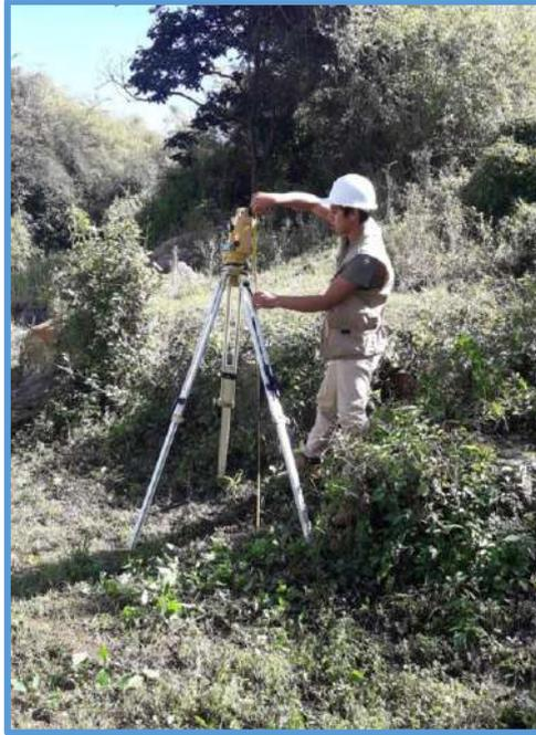
Fotografía 17: En la fotografía se puede apreciar el proceso de medición del hilo de instrumento que sirvió como dato para el cálculo de levantamiento topográfico.
