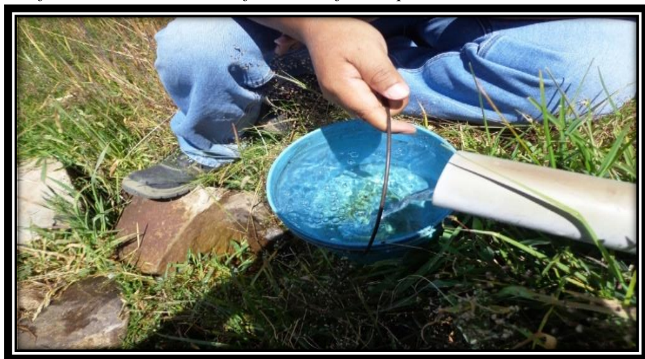
Gráfico 8: Calculando el aforo de la fuente por el método volumétrico
