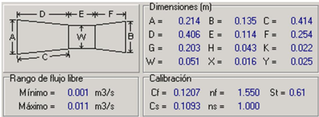
Figura 4.10: Dimensiones del medidor Parshall
