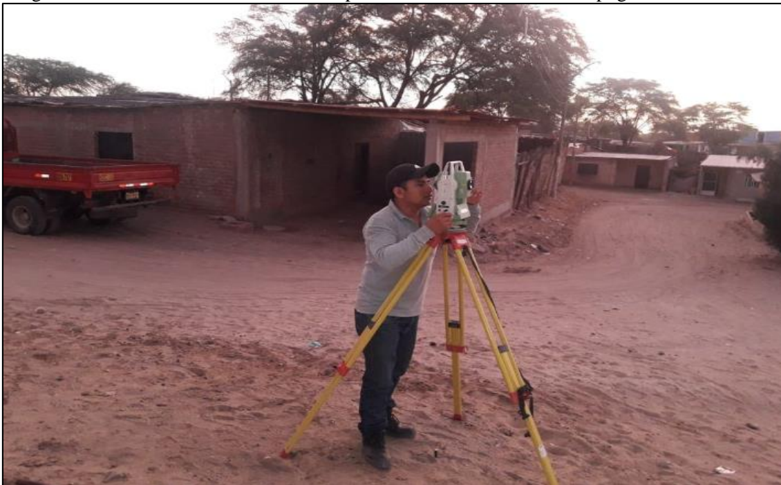
Imagen 2. Vista N°02 verificación de BM para inicio de levantamiento topográfico
