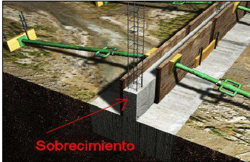
Grafico 06: Sobrecimiento de concreto
