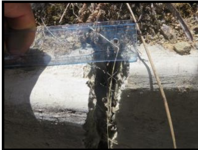
Imagen 25. Toma de medida de las aberturas de las grietas
