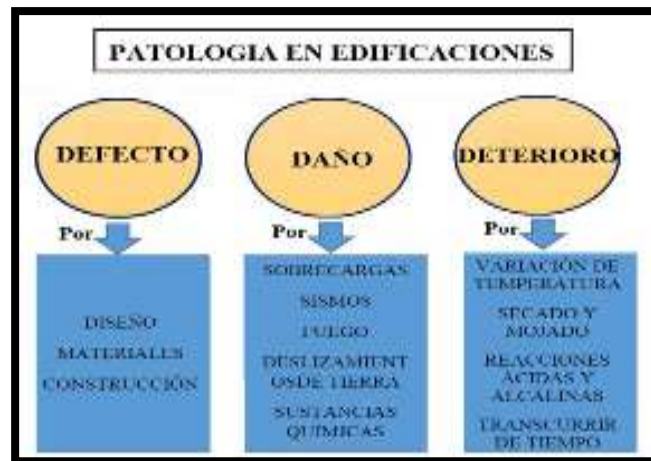
Figura 15. Causas de las Patologías.
