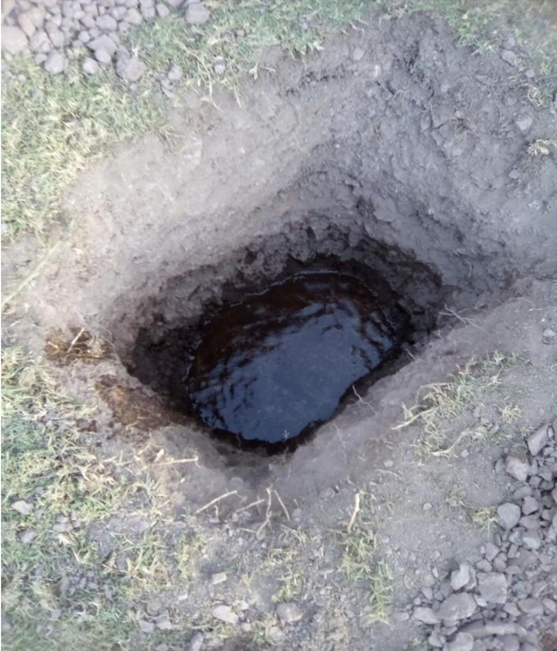
Figura 4.7: Prueba de infiltración para UBS.
