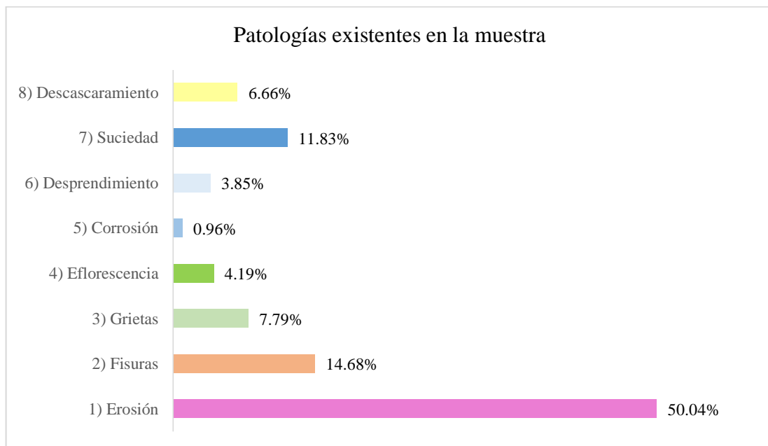
Figura 185: Porcentaje de patologías existentes en la muestra
