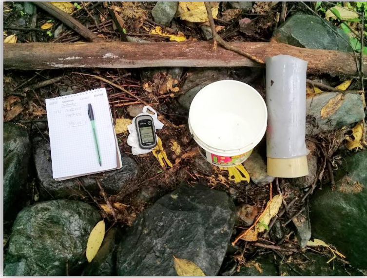
fotografía 9. instrumentos utilizados para medir caudal. Fuente: Elaboración propia
