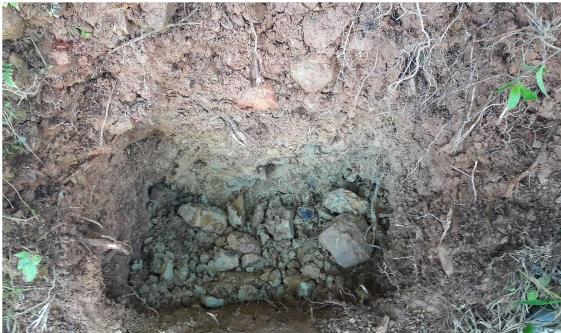
Figura 48. En esta imagen se puede observar la calicata realizado para obtener las muestras para el estudio de mecánica de suelos.
