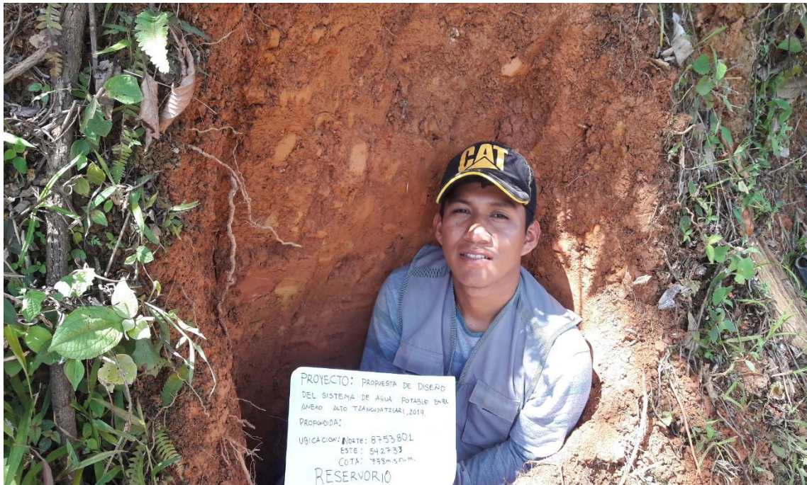
Figura 47. En esta imagen se puede apreciar realizando calicatas para obtener las muestras del estudio de mecánica de suelo
