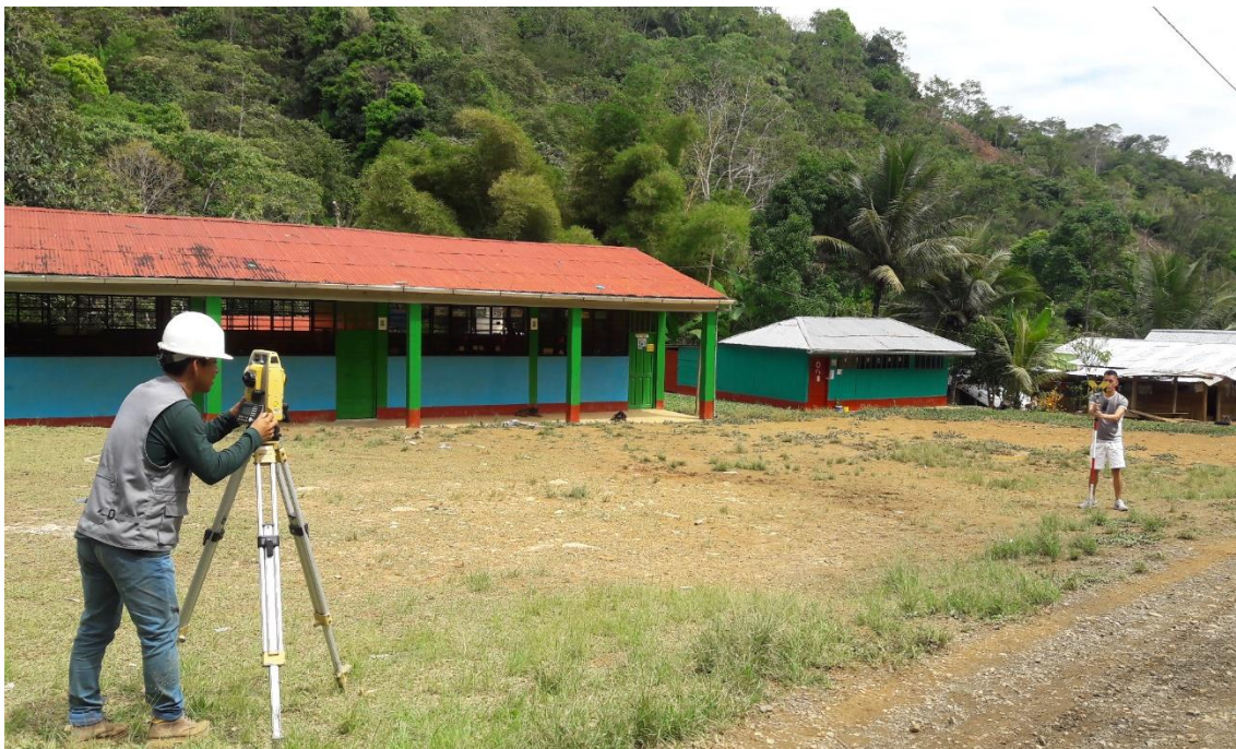
Figura 50. En esta imagen se puede observar realizando levantamiento topográfico de las calles del Anexo Alto Tzancuvatziari.
