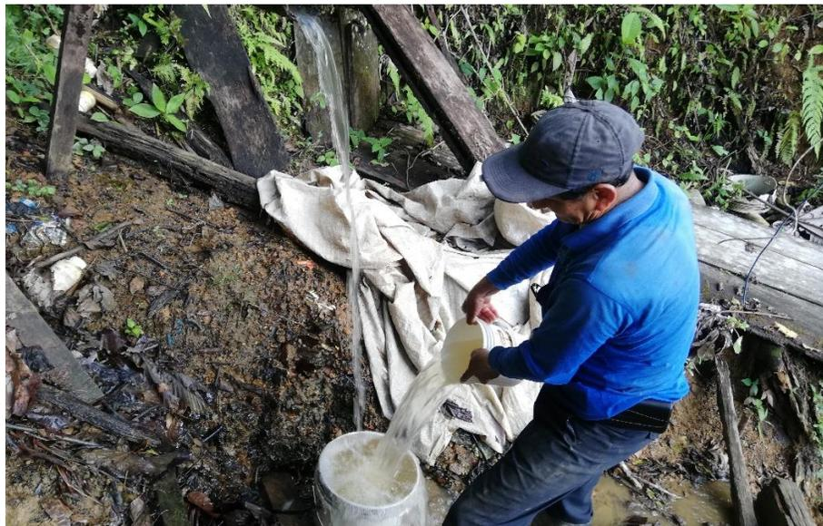
**Imagen N° 02:** Se puede apreciar aforando el caudal en el sector nueva esperanza, distrito de Pangoa, provincia de Satipo, región Junín.
