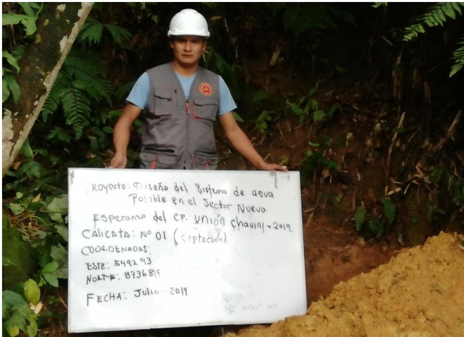
**Imagen N° 04:** Se puede apreciar la recopilación de muestra de la calicata N° 01 para la captación en el sector nueva esperanza, distrito de Pangoa, provincia de Satipo, región Junín.
