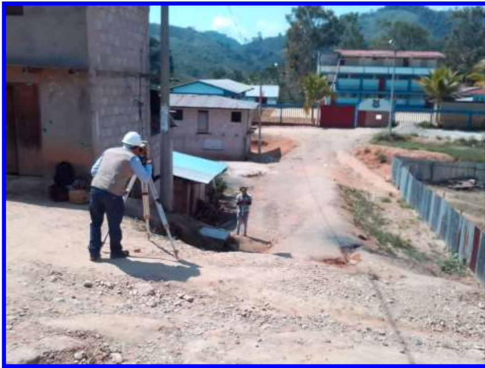
Foto N° 03.- Levantamiento topográfico del centro poblado de Condado Pichikiari.
