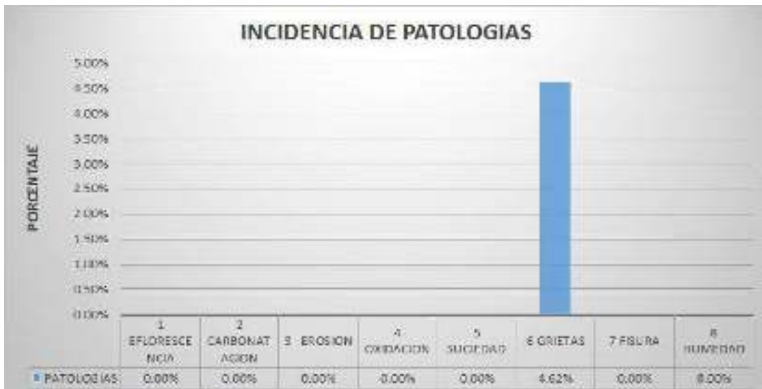
Grafico 22: Porcentaje de área afectado en viga de la unidad de muestra 2.
