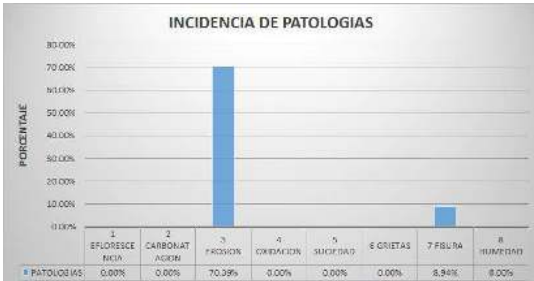
Grafico 152: Porcentaje de área afectado en viga de la unidad de muestra 15.
