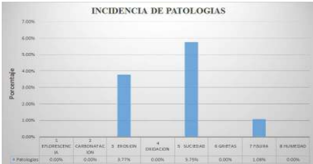
Grafico 174: Porcentaje de área afectada en muro de la unidad de muestra 17.
