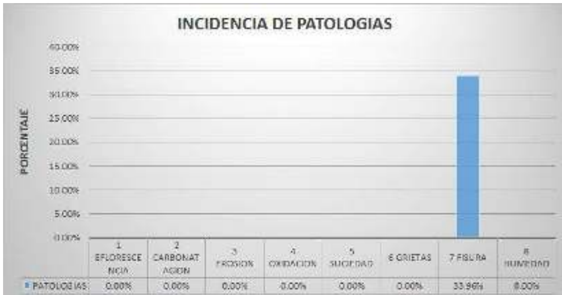
Grafico 172: Porcentaje de área afectado en viga de la unidad de muestra 17.
