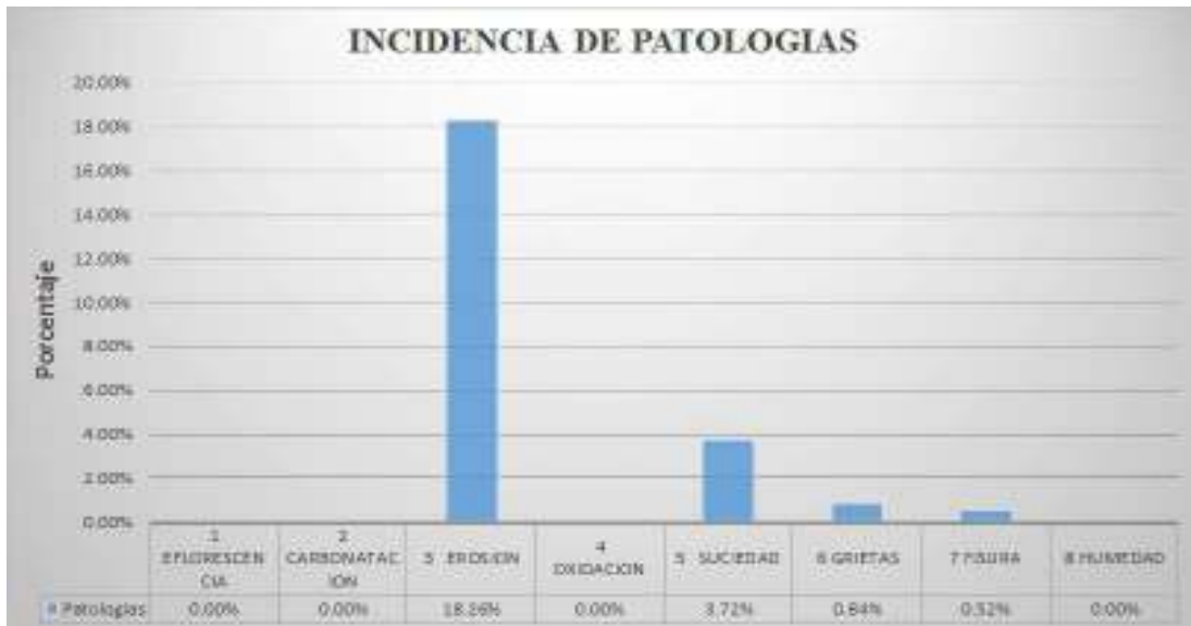
Gráfico 124: Porcentaje de área afectada en muro de la unidad de muestra 12.
