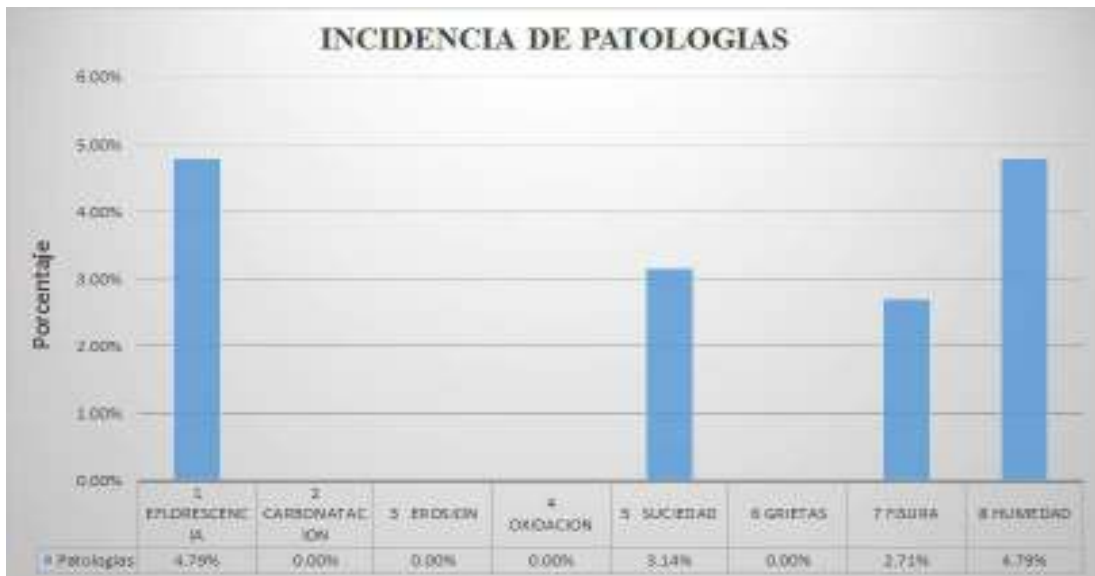
Grafico 64: Porcentaje de área afectada en muro de la unidad de muestra 6.
