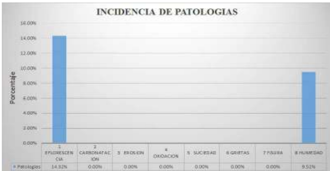
Grafico 34: Porcentaje de área afectada en muro de la unidad de muestra 3.
