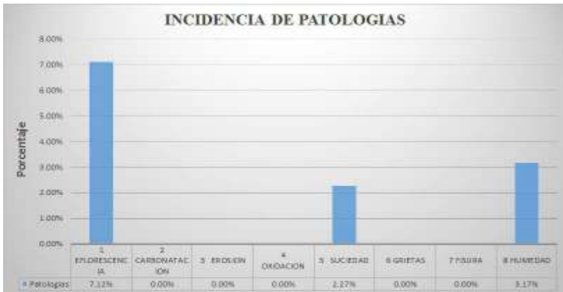
Grafico 44: Porcentaje de área afectada en muro de la unidad de muestra 4.
