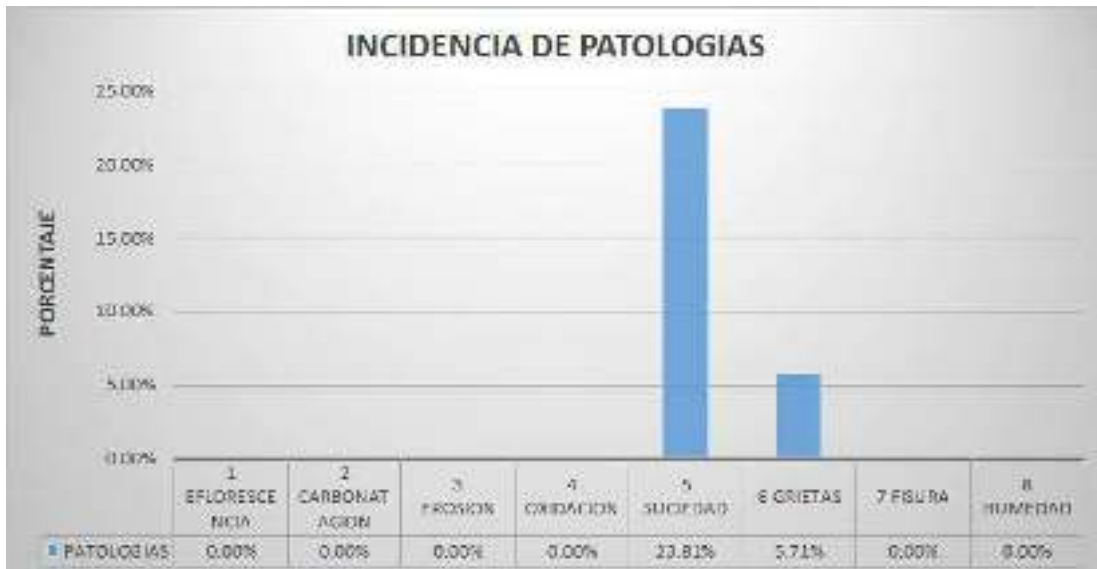
Grafico 52: Porcentaje de área afectado en viga de la unidad de muestra 5.
