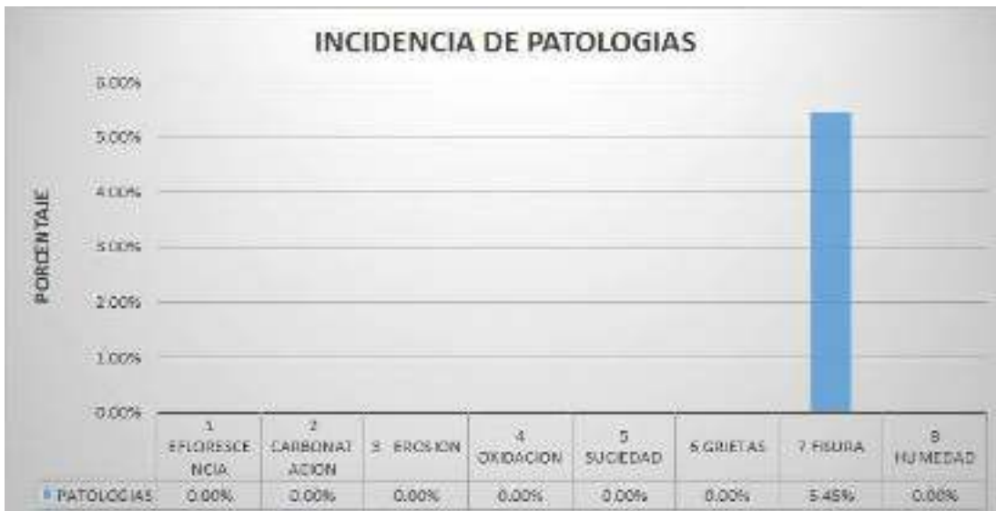
Grafico 92: Porcentaje de área afectado en viga de la unidad de muestra 9.
