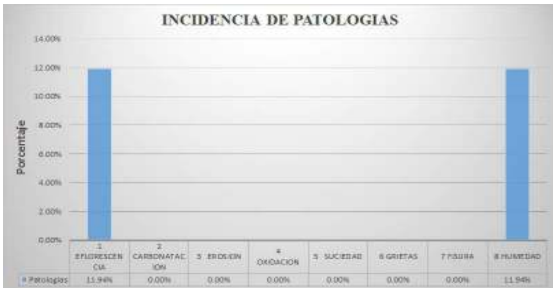
Grafico 24: Porcentaje de área afectada en muro de la unidad de muestra 2.
