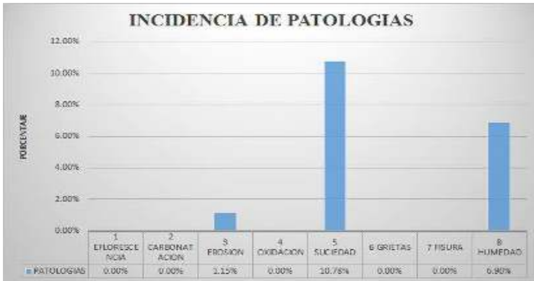
Gráfico 10: Porcentaje de área afectada en columna de la unidad de muestra1.
