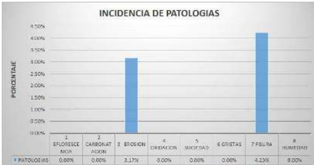
Grafico 142: Porcentaje de área afectado en viga de la unidad de muestra 14.
