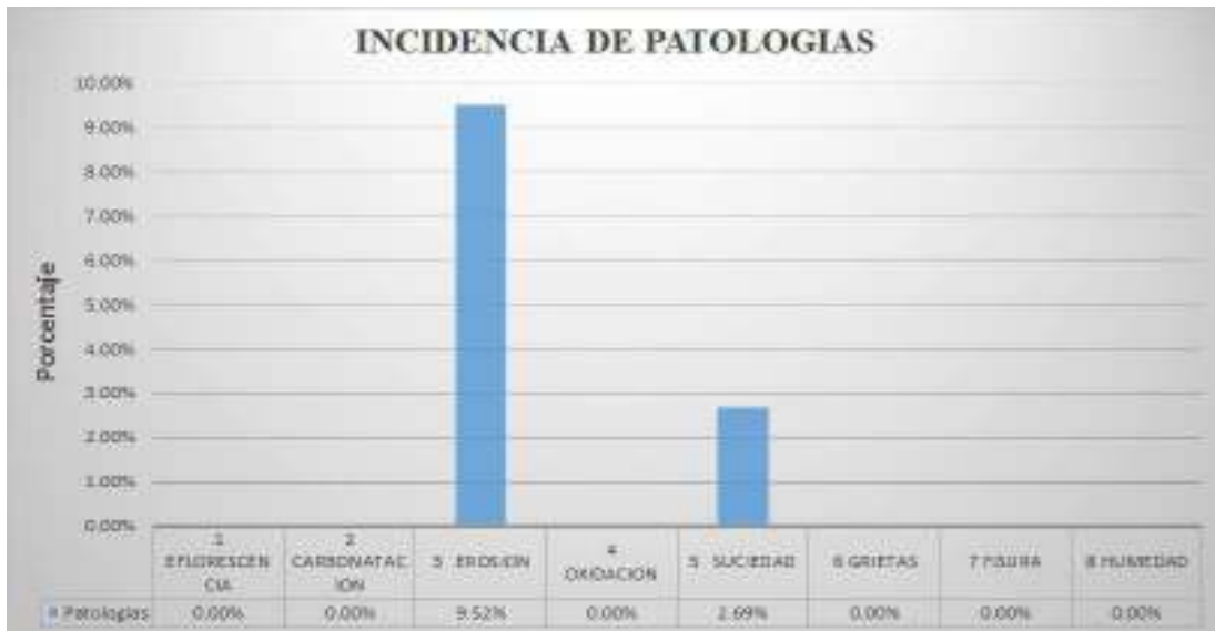
Grafico 104: Porcentaje de área afectada en muro de la unidad de muestra 10.
