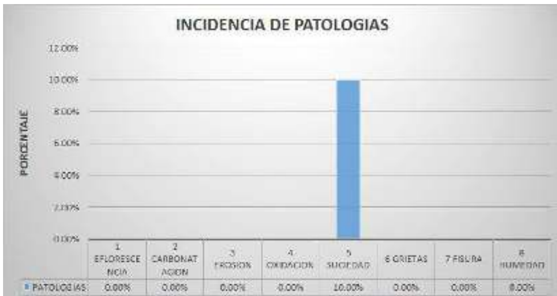
Grafico 112: Porcentaje de área afectado en viga de la unidad de muestra 11.
