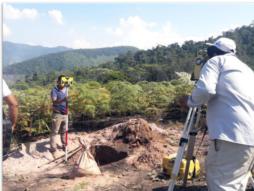
**Fotografía 12:** Levantamiento el área del reservorio donde se esta proyectando
