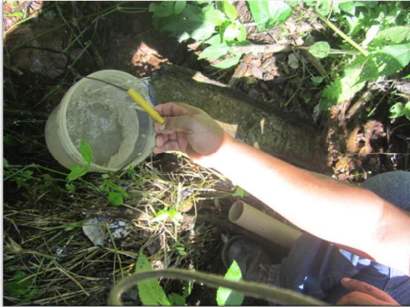
Fotografía 01: Calculando del aforo del caudal
