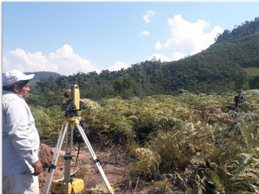
**Fotografía 10:** Levantamiento topográfico en el reservorio
