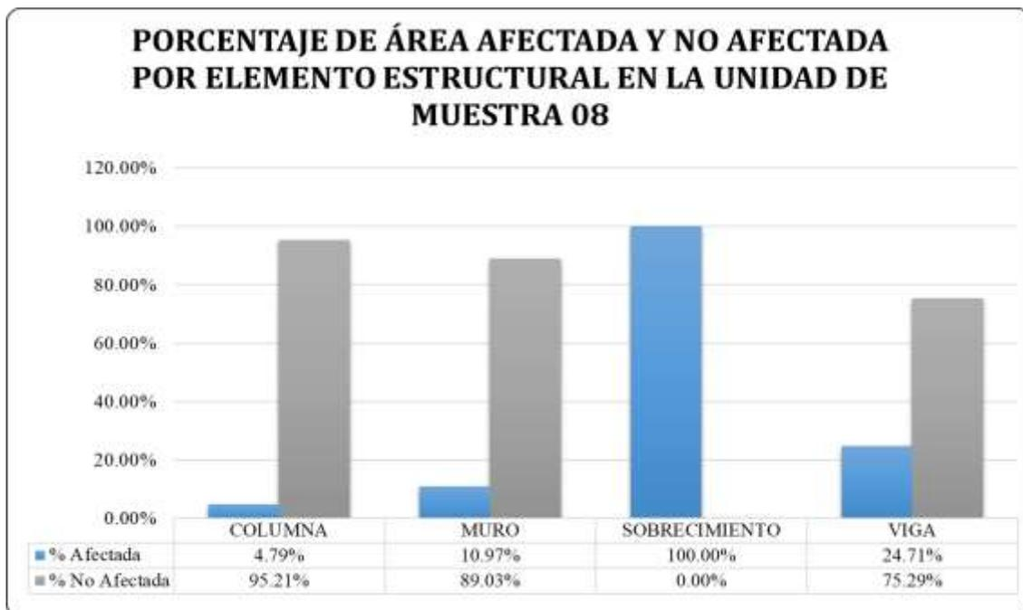
**Figura 59:** Porcentaje de Área Afectada y No Afectada por Elemento Estructural en la Unidad de Muestra 08.
