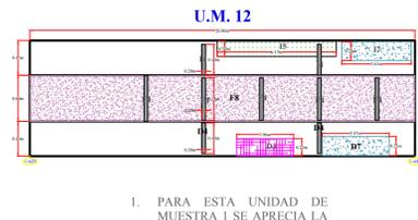
1. PARA ESTA UNIDAD DE MUESTRA 1 SE APRECIA LA PATOLOGÍA EROSIÓN, VEGETACIÓN, DESCASCAMIENTO, EFLORESCENCIA Y SELLO DE JUNTAS, POR LO QUE SE APLICA LA REPARACION 1,4,5,6,7
