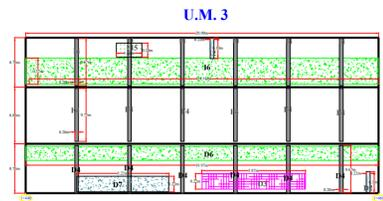
3. PARA ESTA UNIDAD DE MUESTRA 3 SE APRECIA LA PATOLOGÍA MOHO, FISURA, VEGETACIÓN, EFLORESCENCIA, DESCASCAMIENTO Y SELLO DE JUNTAS, POR LO QUE SE APLICA LA REPARACION 3,7,4,5,7
