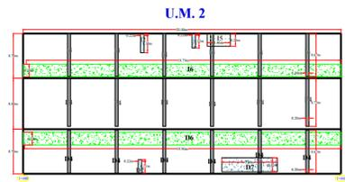
2. PARA ESTA UNIDAD DE MUESTRA 2 SE APRECIA LA PATOLOGÍA MOHO, FISURA, EFLORESCENCIA Y SELLO DE JUNTAS, POR LO QUE SE APLICA LA REPARACION 3,7,8
