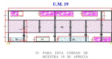
19. PARA ESTA UNIDAD DE MUESTRA 19 SE APRECIA LA PATOLOGÍA EROSIÓN, VEGETACIÓN, DESCASCAMIENTO, EFLORESCENCIA Y SELLO DE JUNTAS, POR LO QUE SE APLICA LA REPARACION 1,4,5,6,8
