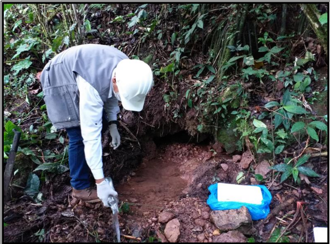
Figura 26. Toma de muestra de para el análisis físico químico y bacteriológico del agua.
