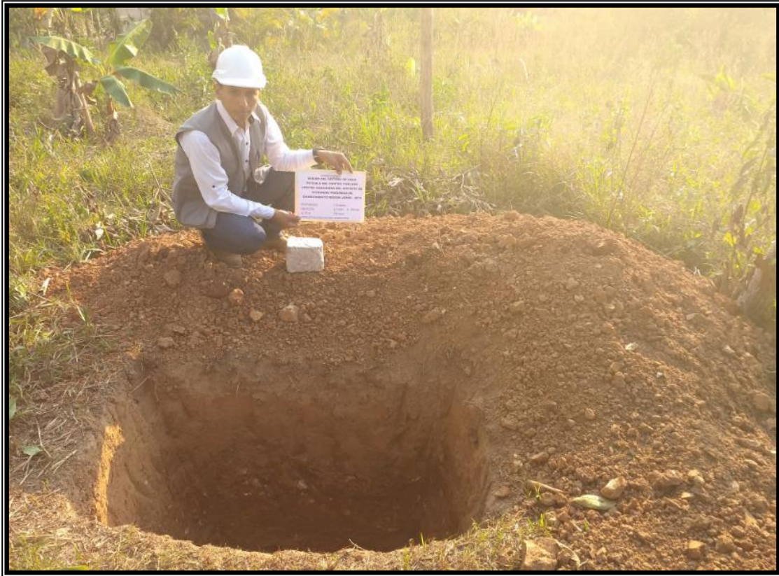
Figura 39. Toma de muestra inalterada para el análisis de suelo de la zona proyectada para el reservorio.
