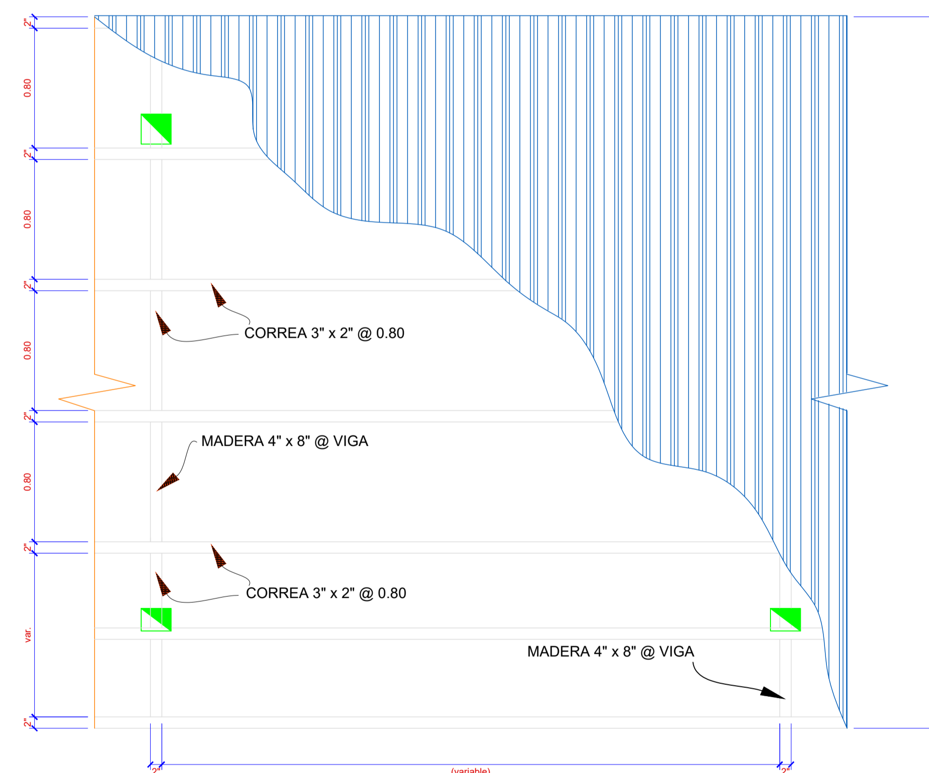
DETALLE DE TECHO ESCALA 1:30
