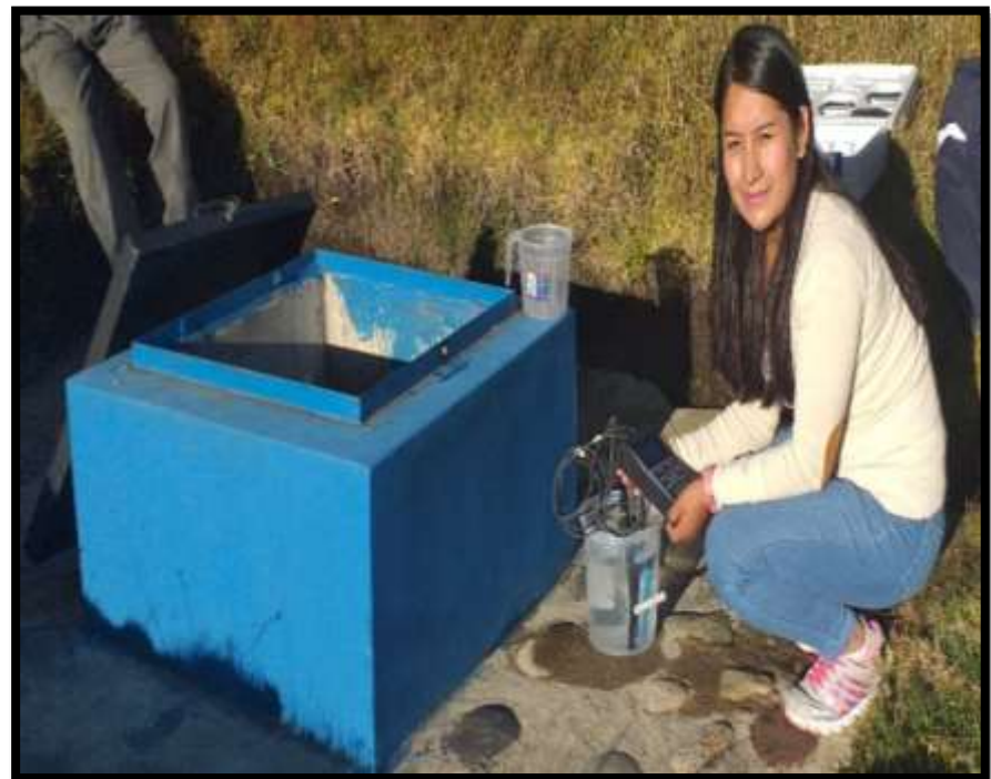
Fotografía N° 21: Análisis de agua con el equipo multiparametro.
