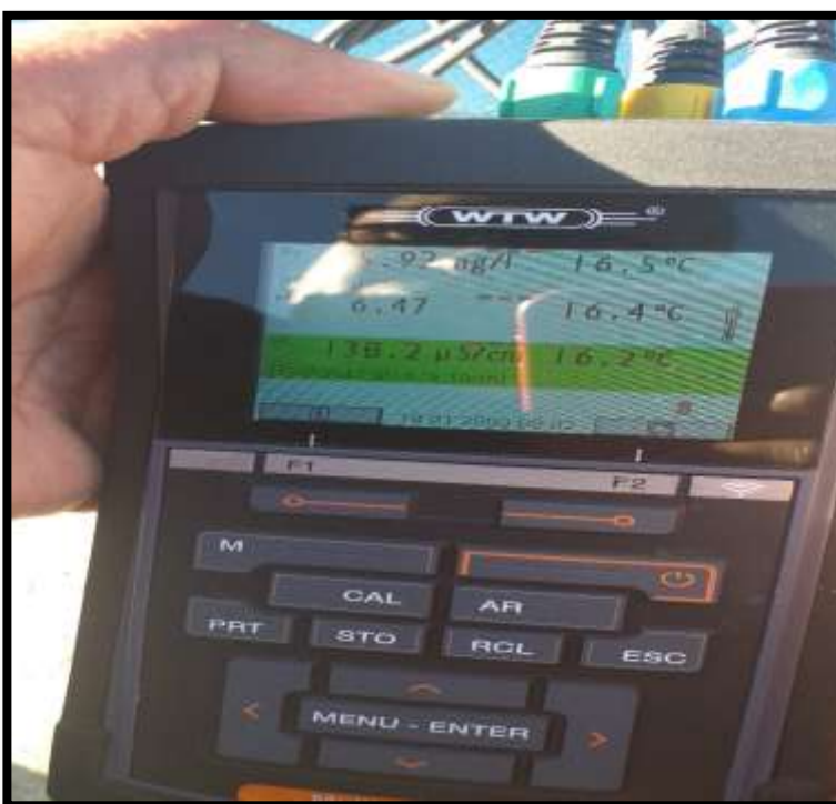
Fotografía N° 22: Análisis de agua con el equipo multiparametro.
