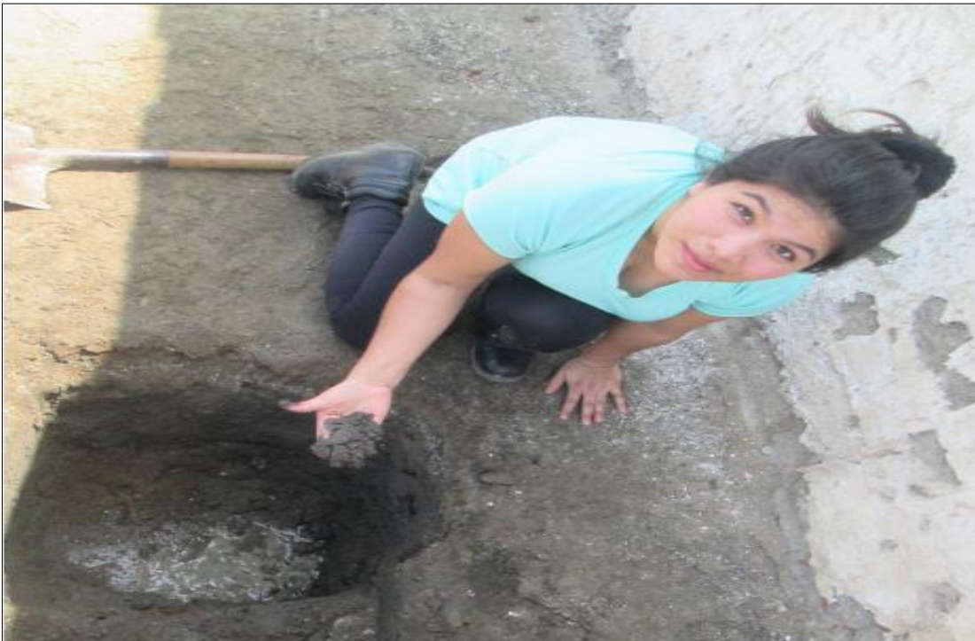
Fotografía 04. Se encontró el nivel de capa freática en una profundidad de 0.45 cm.
