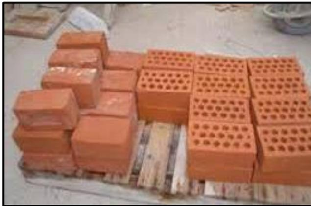
**Figura 14.** Unidades de albañilería
