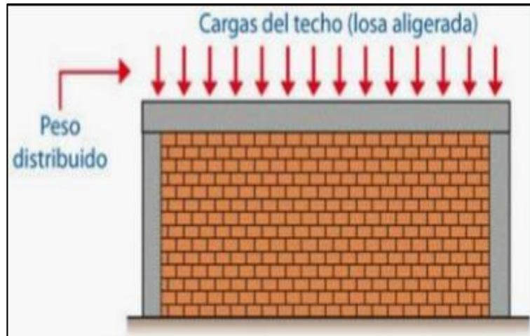
Figura 04. Muro portante. Nota. Fuente: Mayer, M. (2014).
