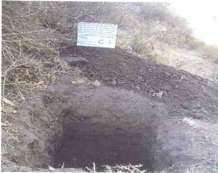
Foto N° 03.- En la toma se aprecia una vista detallada de la Calicata C-01.
