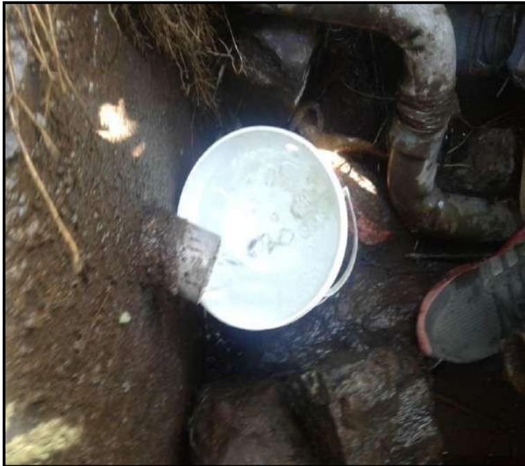
Figura 27: Medición para calculo volumétrico caudal de la fuente
