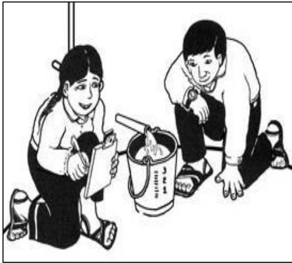
Figura 11: Aforo de agua con el método volumétrico
