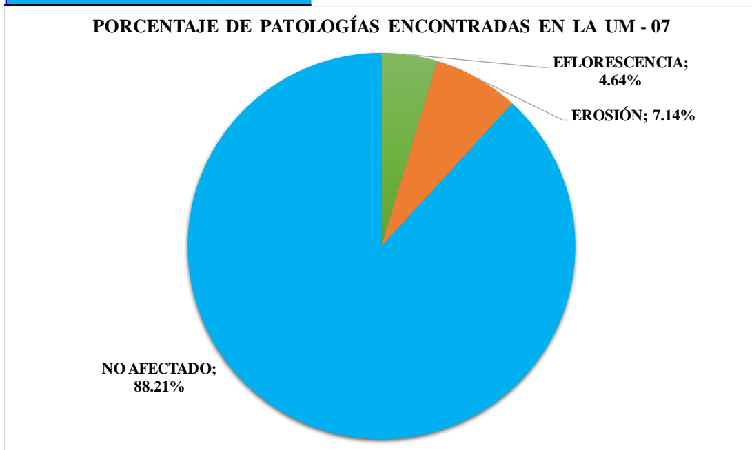
Figura 45: Porcentaje de patologías encontradas en la Unidad de Muestra 7
