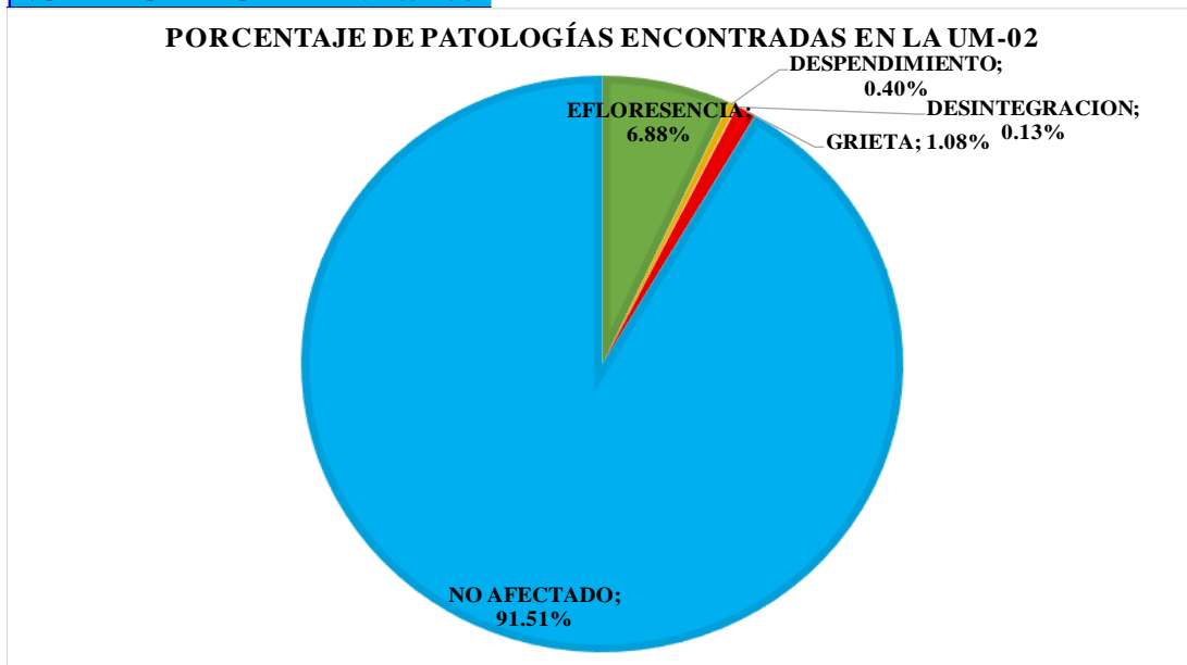
Figura 25: Porcentaje de patologías encontradas en la Unidad de Muestra 2.
