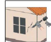
**Paso 01** Se hace el marcado de toda el área afectada pudiendo ser Horizontal y vertical, como hiciste fisuras tanto en los muros tarrajeados, se procede a picar con ayuda del cincel y comba en forma "V" 1.5 cm en los bordes de la fisura (en caso de ser muro tarrajado hasta llegar al ladrillo). Con la ayuda de un escobilla se procede a limpiar todo tipo de polvo suelto que existe. Se Humedece la parte a resanar.
