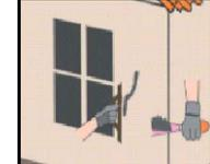
**Paso 02** Se continua con aplicar un puente de adherencia de concreto nuevo y concreto antiguo la preparación y aplicación se dará de acuerdo a la ficha técnica, seguidamente se prepara un mortero de relación de 4:1, para empezar a resanar la parte dañada y con la ayuda de la plancha dar un acabado homogeo sobre la superficie de la pared. Como parte del procedimiento final se procede a humedecer por 3 días la parte dañada en caso de muros y 7 días en caso de columnas y sobre cimiento.
