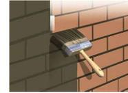
**Paso 02** Luego que la superficie se encuentra limpia y seca, para una mayor protección se procede aplicar un aditivo impermeabilizante que le dará mayor protección a los muros expuestos, este aditivo se prepara de acuerdo a la ficha técnica especificada, la aplicaciones realizara con una brocha de modo como se estuviese pintando, se aplicara dos veces para tener una mayor protección.
