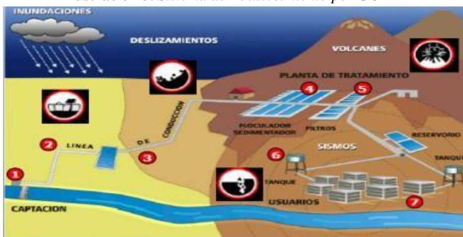
Ilustración 3. Sistema de Abastecimiento por GCT
