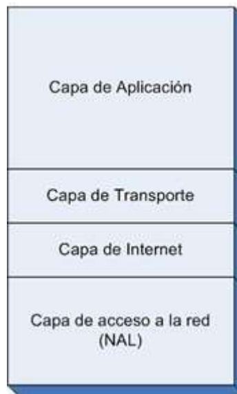
Figura N° 24: Modelo TCP / IP
