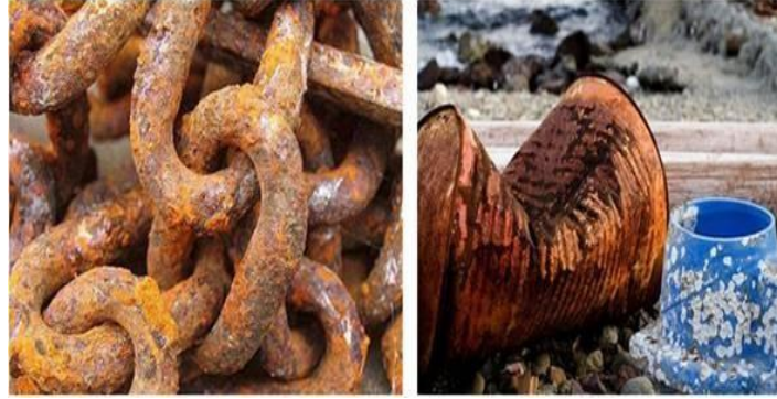
Gráfico 17: Oxidación de lata y fierro - Fuente: Lezama 31
