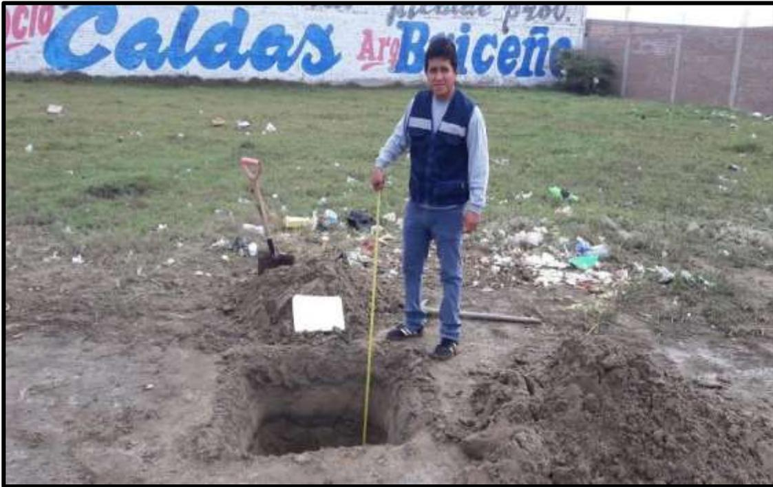
*Imagen 05:* Se verifica el nivel de la napa freática presente en el terreno.
